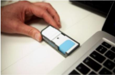
Photo du séquenceur MinION (Oxford nanopore technology®) : séquenceur à usage unique intégré dans une clé USB dont il tire son alimentation. La séquence de l'ADN issue par exemple du sang est directement transférée sur l'ordinateur (le tout 900\$). La même technologie est développée chez le SmidgION (Oxford nanopore technology®) qui lui se relie à un téléphone portable.
